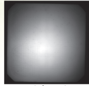
Fig.1 従来手法でのPL測定画像 周囲と中央の輝度差が大きい
