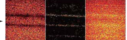
TOF-SIMSによる配向膜上汚染分析
