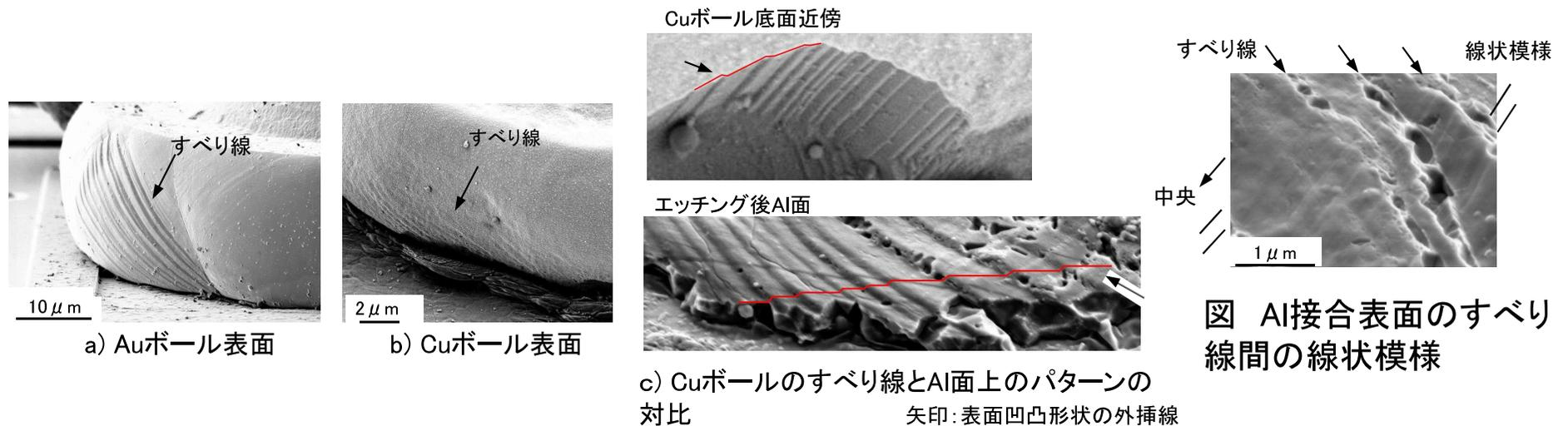
図 1stボンドボール表面に見られるすべり線との対比
