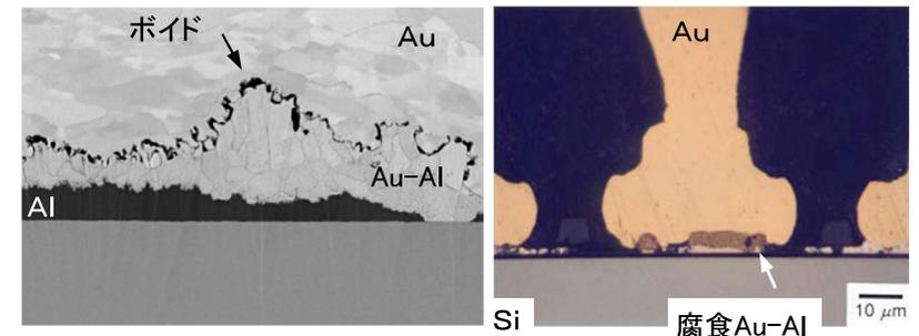
図 Au-Al化合物に見られるボイドと腐食
