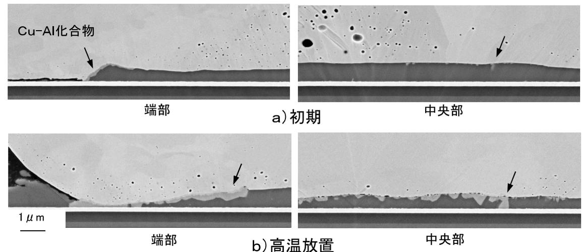
図 接合界面のCu-Al化合物の初期と高温放置、及び端部と中央部の比較(被覆有り試料)
