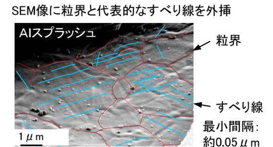
図 ボンディング周囲のAl電極表面に見られるすべり線
