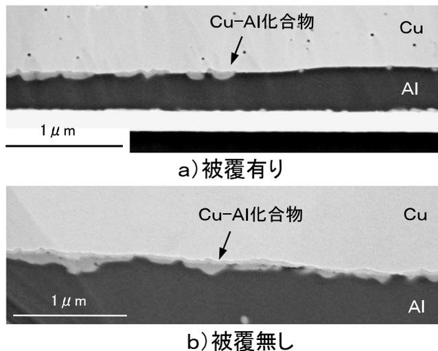
図 Cuワイヤの被覆Pd有無における電極接合界面のCu-Al化合物(初期品中央部)
