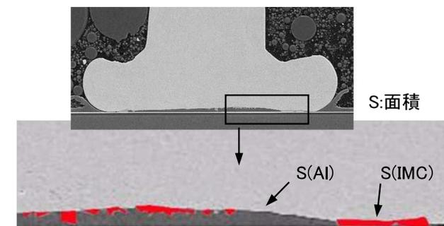
図 Cu-Al化合物(IMC)の抽出(色付け部)
