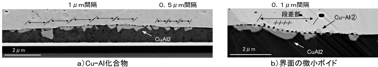
図 Cu-Al化合物の間隔と微小ボイドの間隔
