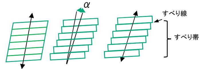
すべり面に沿って相対的ずれ → 角度  $\alpha$  軸での回転
