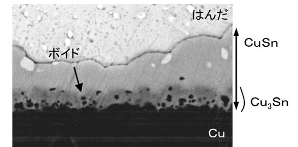
図 Cu-はんだ界面のCu-Sn化合物に見られるボイド
