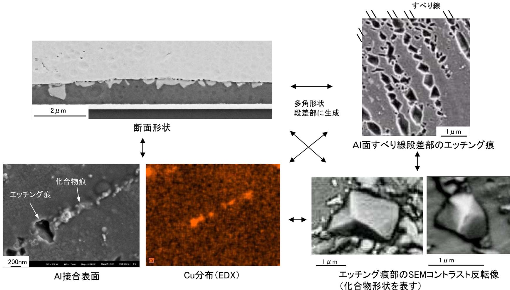
図 Al接合面上のエッチング痕とCu-Al化合物痕およびその形状
