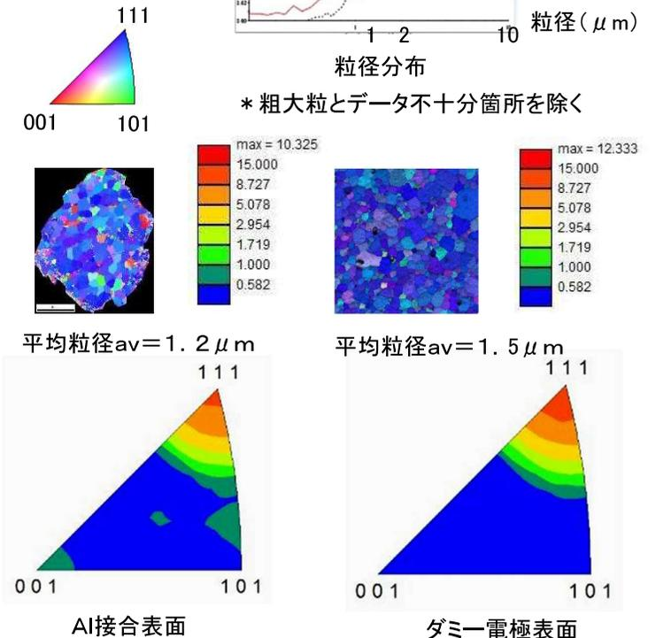
d) Al表面の結晶方位 (ND逆極点図) と平均粒系の比較
