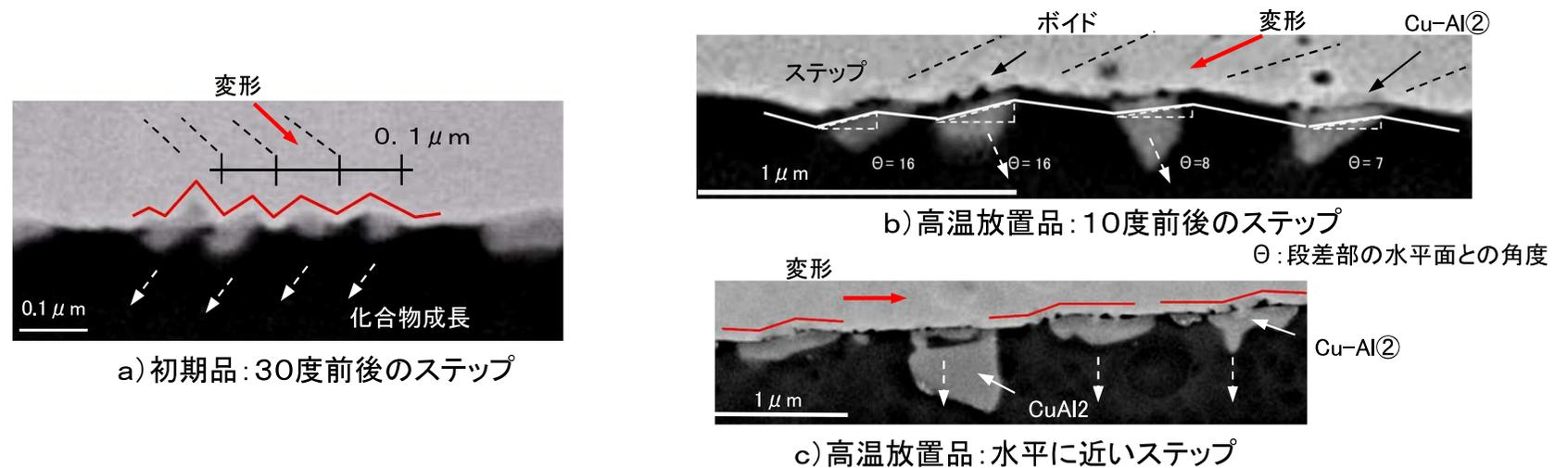
図 接合界面の階段状ステップとCu-Al化合物及び微小ボイド
