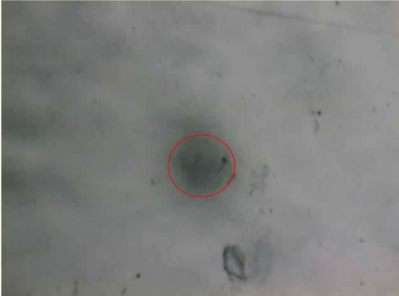
刃先 : 50 $\mu\text{m}$     異物 : 約 10 $\mu\text{m}\Phi$
