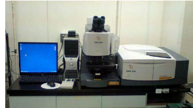
有機物分子構造中の**官能基**と呼ばれる部分で吸収される赤外線波長スペクトルにより、物質を特定する手法である。
