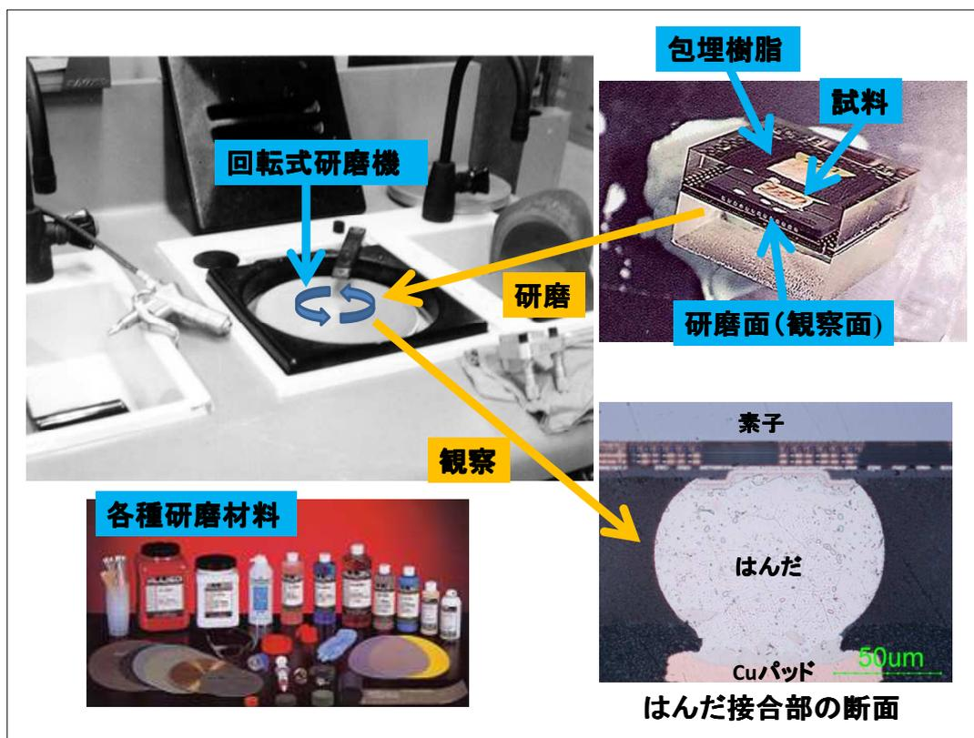
図 5. 機械研磨による断面作製の例
