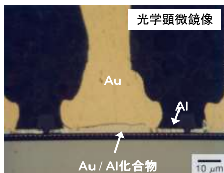
光学顕微鏡なら Au / Al 化合物が一目で分かる
