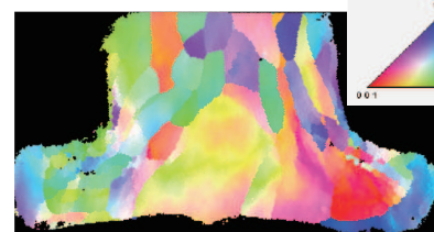
逆極点図方位マップ (Inverse Pole Figure: IPF マップ) 逆極点図を基にした結晶方位マップ
